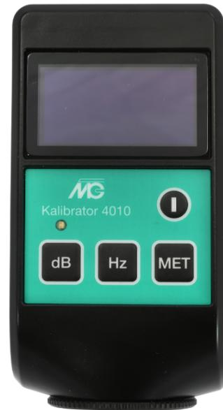
Der akustische Kalibrator 4010 ist eine akustische Schallquelle zum Kalibrieren und Überprüfen von Schallpegelmessgeräten. Er entspricht den Anforderungen an Klasse 1-Kalibratoren gemäß IEC 60942 und kann zwei unterschiedliche Schalldruckpegel mit zwei unterschiedlichen Frequenzen erzeugen, womit die Pegellinearität und die Frequenzbewertung von Schallpegelmessgeräten überprüft werden können.
