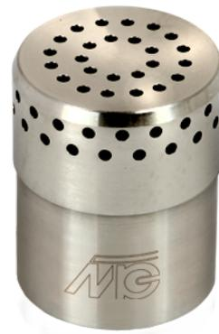
Die MK 255 hat einen freifeldentzerrten Frequenzgang des Übertragungsmaßes und ist insbesondere für akustische Messungen im freien Schallfeld mit 0 Grad Einfallswinkel konzipiert.
